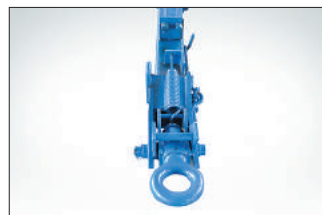
Петля фаркопа для агрегатирования с тракторами «Кировец»
